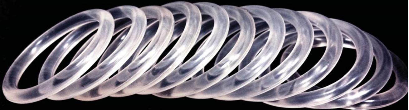
孚瑞科技的E-1270T維持氟橡膠的基礎分子架構，並使用有機物鍵結聯繫。有別於傳統氟橡膠混練中因為使用碳黑與礦物填充物，造成電漿蝕刻或是動態密封的過程中會釋出密封件裏的填充物 (fillers)；使用端為了解決這樣的問題，多透過採購昂貴的全氟橡膠(FFKM)來解決。而孚瑞科技的 E-1270T採用奈米級原料及製程，揚棄傳統橡膠製備工藝中所使用的微粒或粉末填隙技術，造就 Femrex Plus E-1270T成為一超高潔淨度與低粒子釋出的密封材料，也同時也維持著 FKM/Viton 該有的抗化耐溫性。孚瑞科技的 E-1275T特別適合應用在有抗密封件微粒污染需求的半導體製程，真空應用與食品生產。即使在嚴苛的電漿環境下，Femrex Plus E-1270T亦不會汙染蝕刻槽內的樣本與設備。
