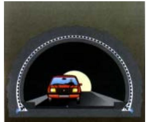
高性能高堅韌性高抗壓力導阻水板可有效隔離潮氣水長期保護建物不受潮氣與水地下水化學性有害物質之侵害。
