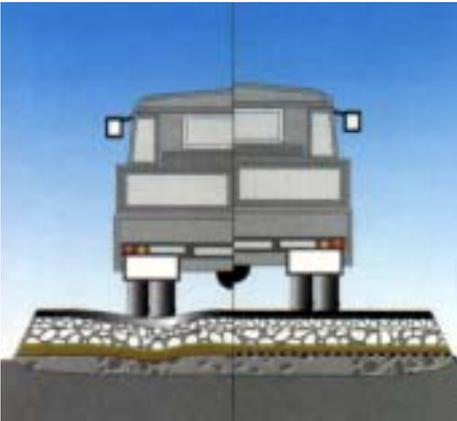
其高性能結構設計，天封膠條式導水板施作，不致地層流失及避免結構層變形，並降低地層之厚度，以使保持原來之設計功能
